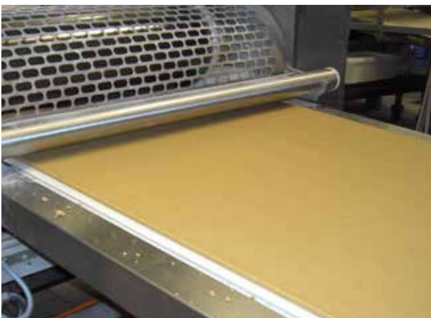
Laminador de masa para producción de hojaldre
